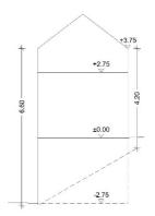
Dachform: Satteldach Dachneidung: 22°-30°
